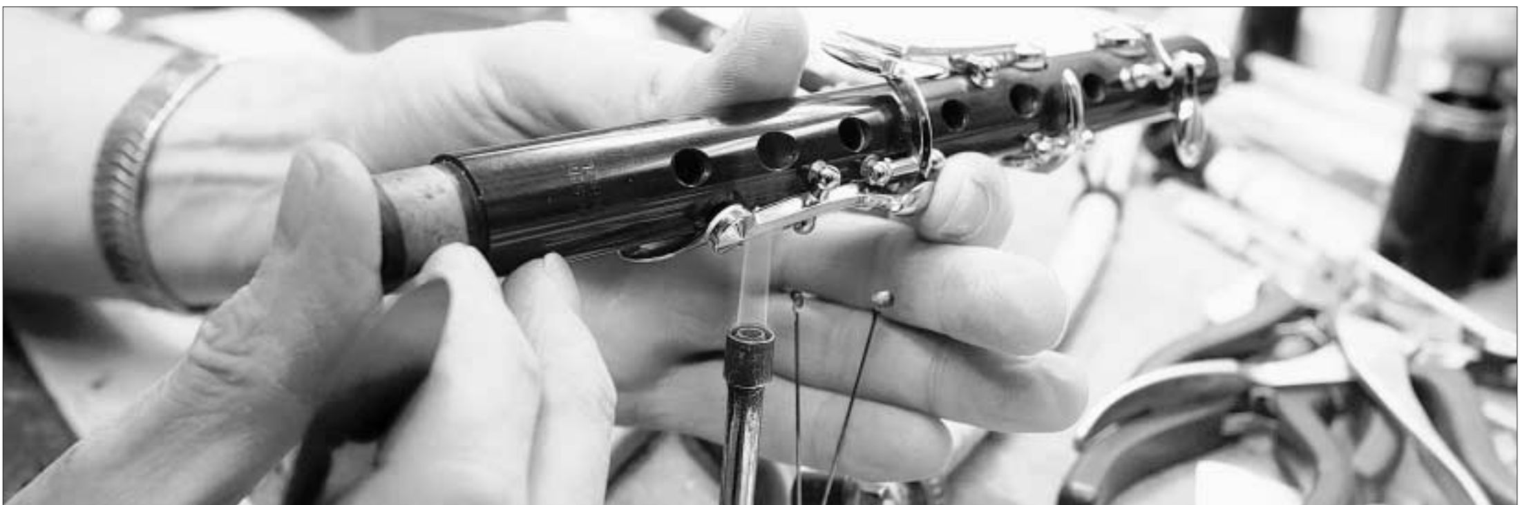
DER RICHTIGE SITZ Nachdem das Pölsterli ausgewechselt ist, wird die Klappe des Piccolos warm gemacht und zurecht gebogen, damit sie richtig aufliegt. Das Heilen des Instruments ist Massarbeit. NICOLE NARS-ZIMMER
